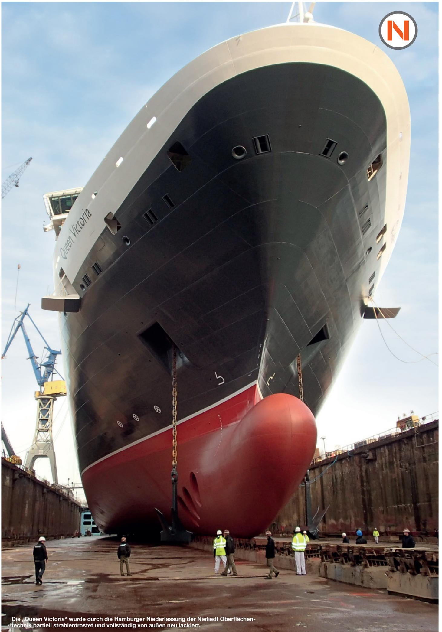
Die „Queen Victoria“ wurde durch die Hamburger Niederlassung der Nietdiedt Oberflächen-technik partiell strahlentrostet und vollständig von außen neu lackiert.
